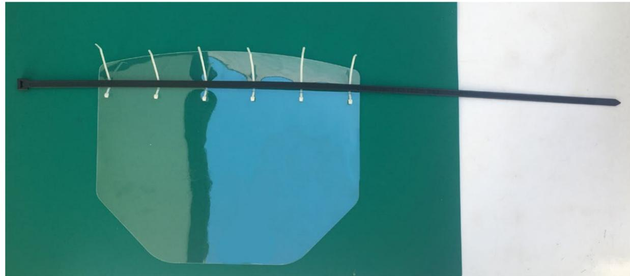
**6a** Abrazadera de plástico (poliamida) grande posicionada con la hebilla a la izquierda del visor.
