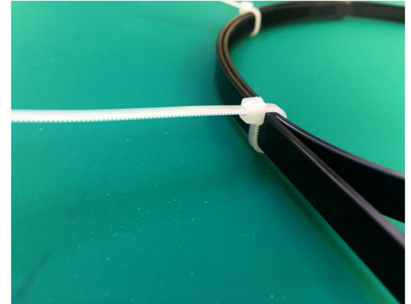
**8b** Detalle del posicionamiento de la abrazadera de plástico pequeña en la corona, con la hebilla hacia la superficie externa-superior.
