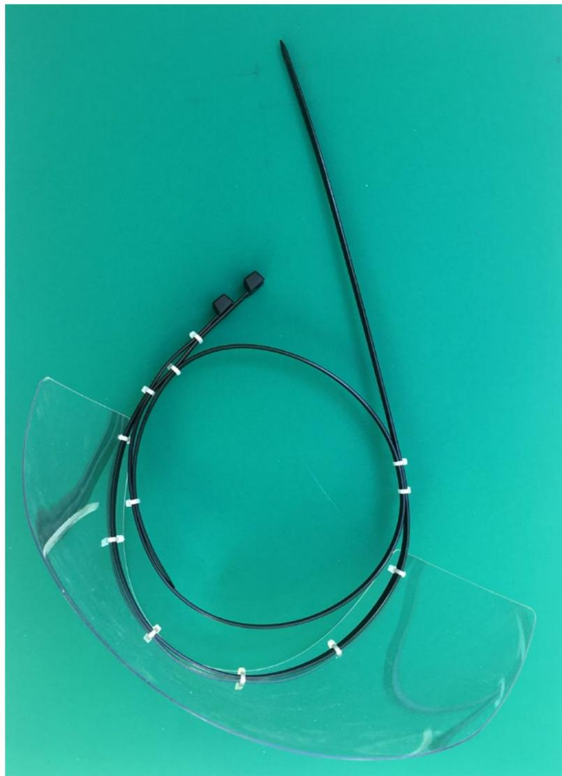
**13** Vista superior del protector facial, en el que dos pares de abrazaderas de plástico fijan el visor a la corona.
